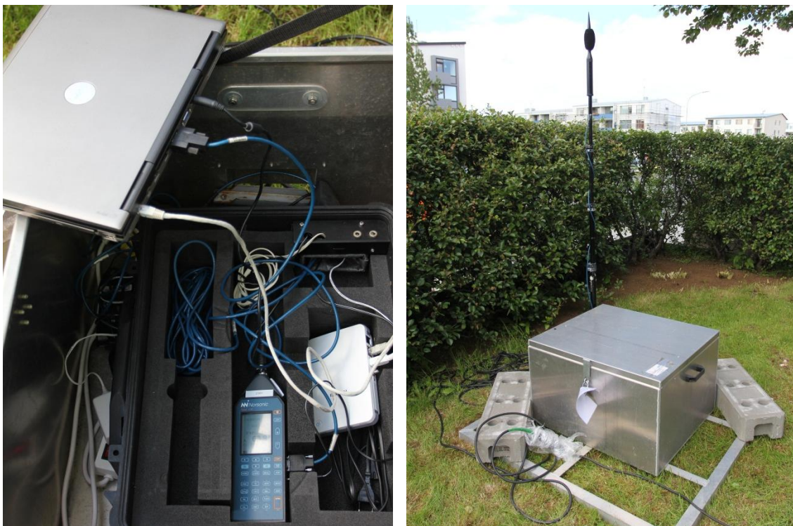
Mynd 1: Búnaður til hljóðmælinga: (a) Nor118 hljóðstigsmælir ásamt búnaði og (b) hljóðnemi og tilheyrandi hlífðarbúnaður.
